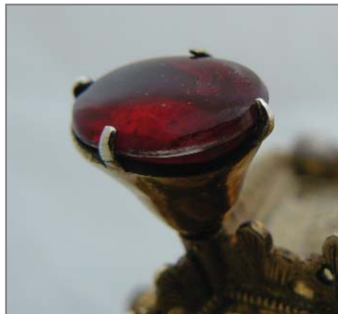
Glasdoublette mit Fuge und pigmentierter Zwischenschicht.
