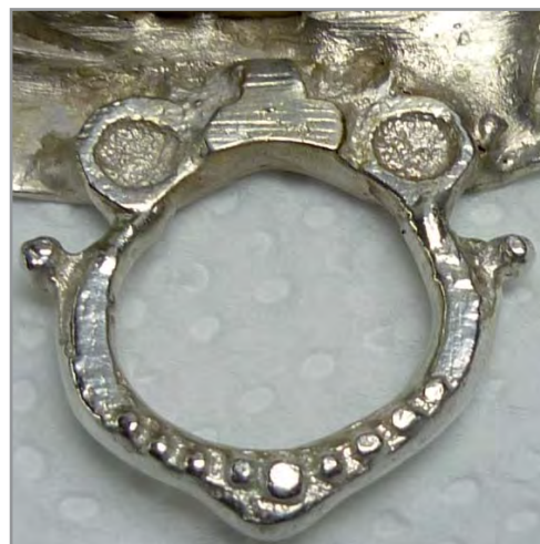
Kettenführung nach den Lötarbeiten
